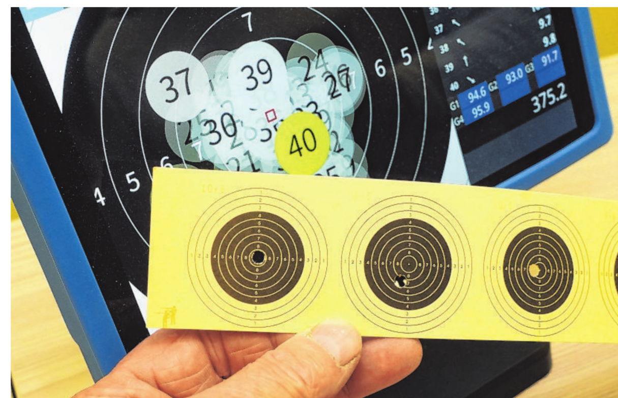
Auswertung gestern und heute: Wurden bisher die Papierstreifen maschinell ausgewertet, übernimmt das nun die digitale Trefferanzeige.
